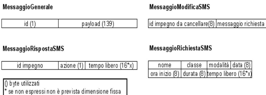
Figura 12: Architettura messaggi SMS
