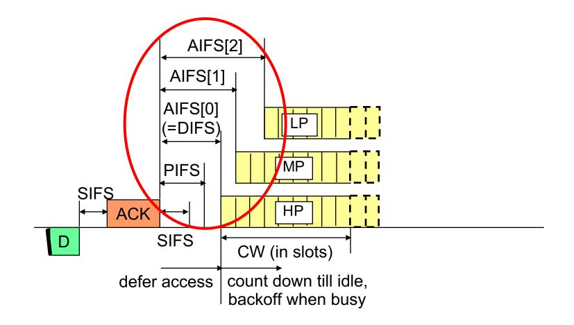
802.11a: slot=9 μs, SIFS=6 μs, PIFS=15 μs, DIFS=24 μs, AIFS ≥34 μs
